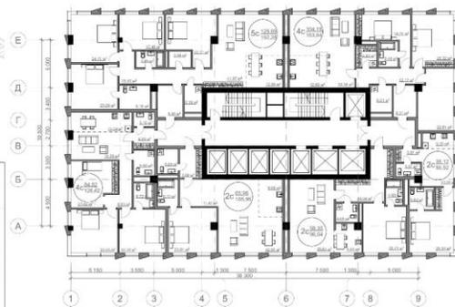
План типового этажа башни «Аит»
